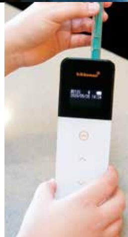
手軽に測定できる清浄度測定器
