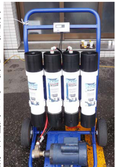
水道水を純水に換えるろ過フィルター装置
